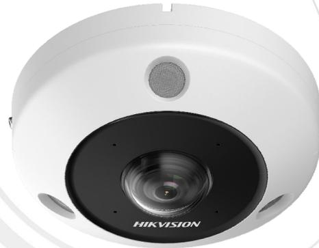
DS-2CD6365G1-IVSは、360度魚眼ネットワークカメラです。プログレッシブスキャンCMOSセンサーにより、最大2560 × 2560の高解像度画像を提供します。最大20種類のライブビュー表示モードは、天井・壁面・卓上の3つの設置方法に対応しております。独立して制御される3つのIRライトは、最大15 mの照射距離に対応し、低照度または全く光が無い環境でも良好な視界を提供します。
